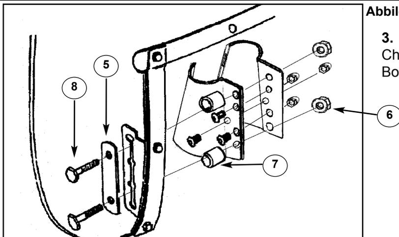
3. Installieren Sie die Windschutzscheibe mit den Chromabstandstücken, der flachen Platte und den Bolzen, wie in Abbildung C dargestellt.
