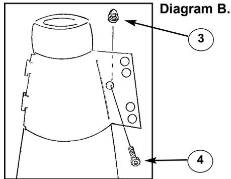
2. Platzieren Sie die Klammern an das obere Ende der Gabel und stecken Sie eine M6x12mm Schraube durch das mittlere Loch der Klammern welche die weitere Montage erleichtert. Führen Sie nun die anderen beiden Innensechskantschrauben M6x12mm durch die inneren Löcher der Klammer und ziehen Sie diese mit den Muttern Handfest an. (Abbildung B)
