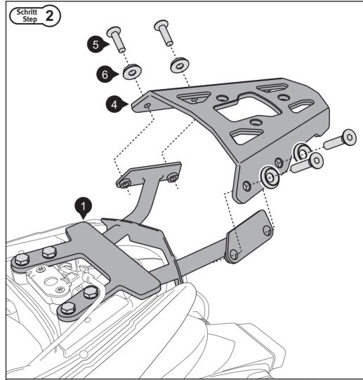
Verschrauben Sie das ALU-RACK (4) wie gezeigt. Sichern Sie die Schrauben mit flüssiger Schraubensicherung. **Anzugsmoment für die Schrauben (5): 20 Nm.**
