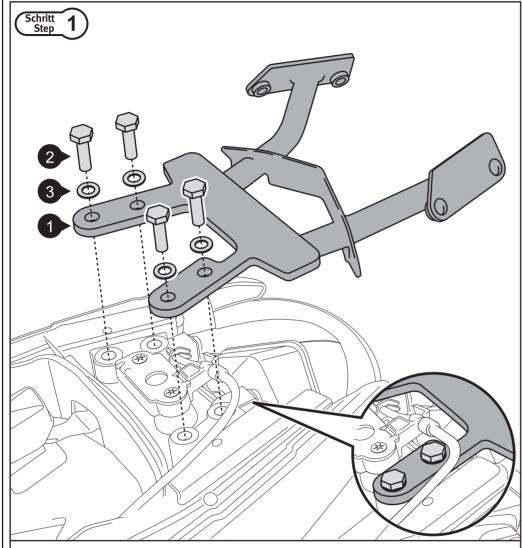
Entfernen Sie den Soziussitz und die obere Heckverkleidung vom Fahrzeug. Montieren Sie den Unterbau (1) wie gezeigt. Sichern Sie die Schrauben mit flüssiger Schraubensicherung.
