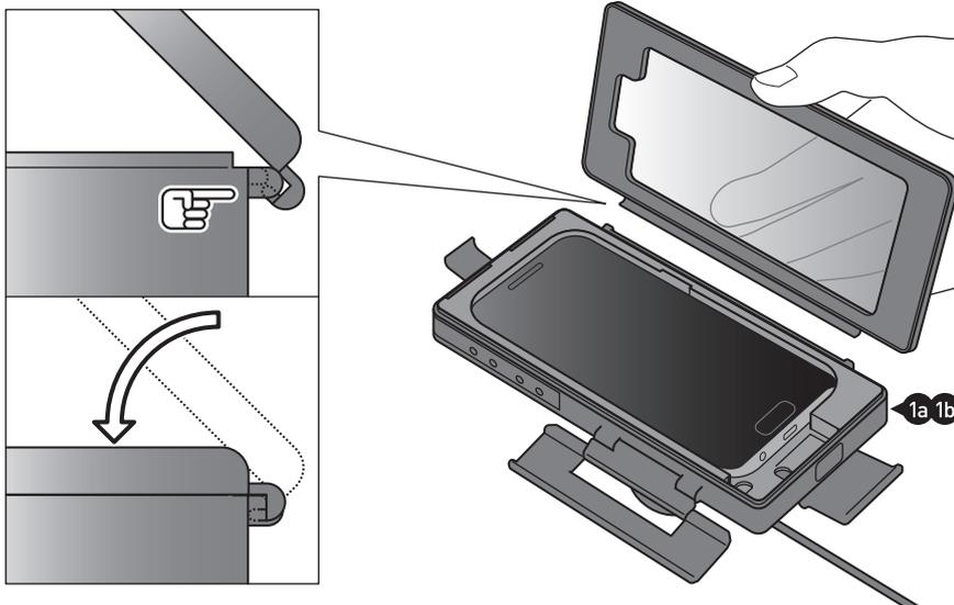
Schließen Sie den Deckel über das offene Scharnier, wie in der linken Detailzeichnung gezeigt.
