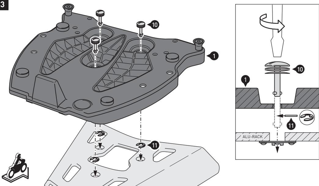
Setzen Sie die Schnellverschlüsse (10) in die Öffnungen der Adapterplatte (1) ein. Sichern Sie die Schnellverschlüsse (10) mit den Sicherungsringen (11), wie in der Detailzeichnung gezeigt.
