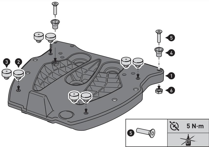
Montieren Sie die gezeigten Teile an der Adapterplatte (1). Ziehen Sie die Schrauben (5) wie vorgegeben an.
