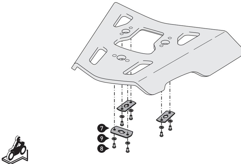
Montieren Sie die gezeigten Teile an dem ALU-RACK Gepäckträger (separat erhältlich). Ziehen Sie die Schrauben (8) vorsichtig handfest an.
