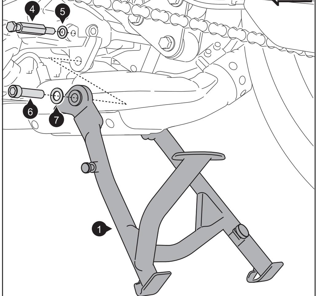
Verschrauben Sie den Federbolzen (4) am Fahrzeug. Sichern Sie den Federbolzen (4) mit flüssiger Schraubensicherung. Ziehen Sie anschließend den Federbolzen (4) an.
