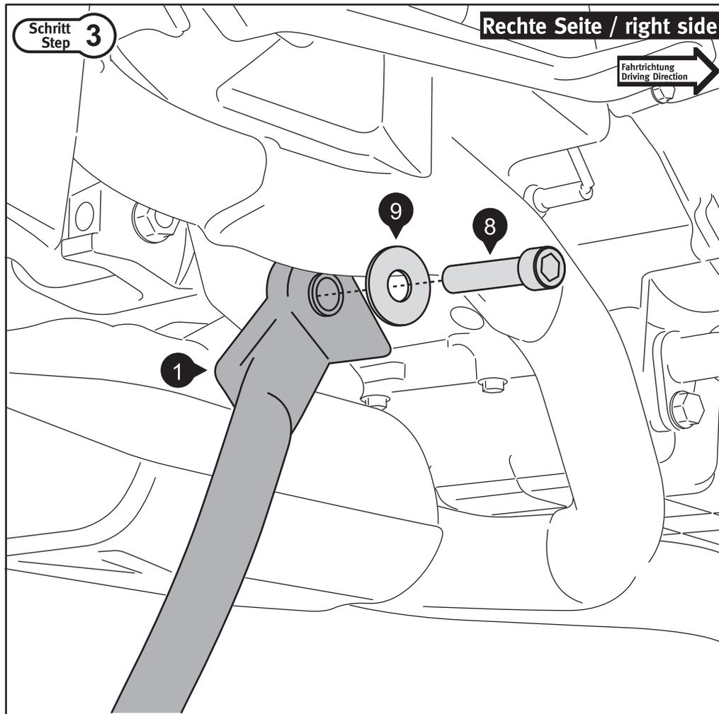
Verschrauben Sie nun den Hauptständer (1) auf der rechten Fahrzeugseite. **ACHTUNG: LINKSGEWINDE!** Sichern Sie Schraube (8) mit flüssiger Schraubensicherung. Ziehen Sie anschließend Schraube (8) an.
