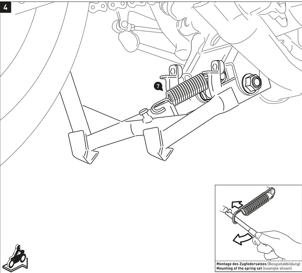
Hängen Sie den Zugfedersatz (7) mit einem geeigneten Werkzeug\* ein, wie in der Detailzeichnung gezeigt.
