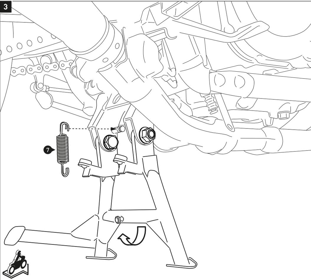
Hängen Sie den Zugfedersatz (7) an den Federanlenkstift am Fahrzeug.
