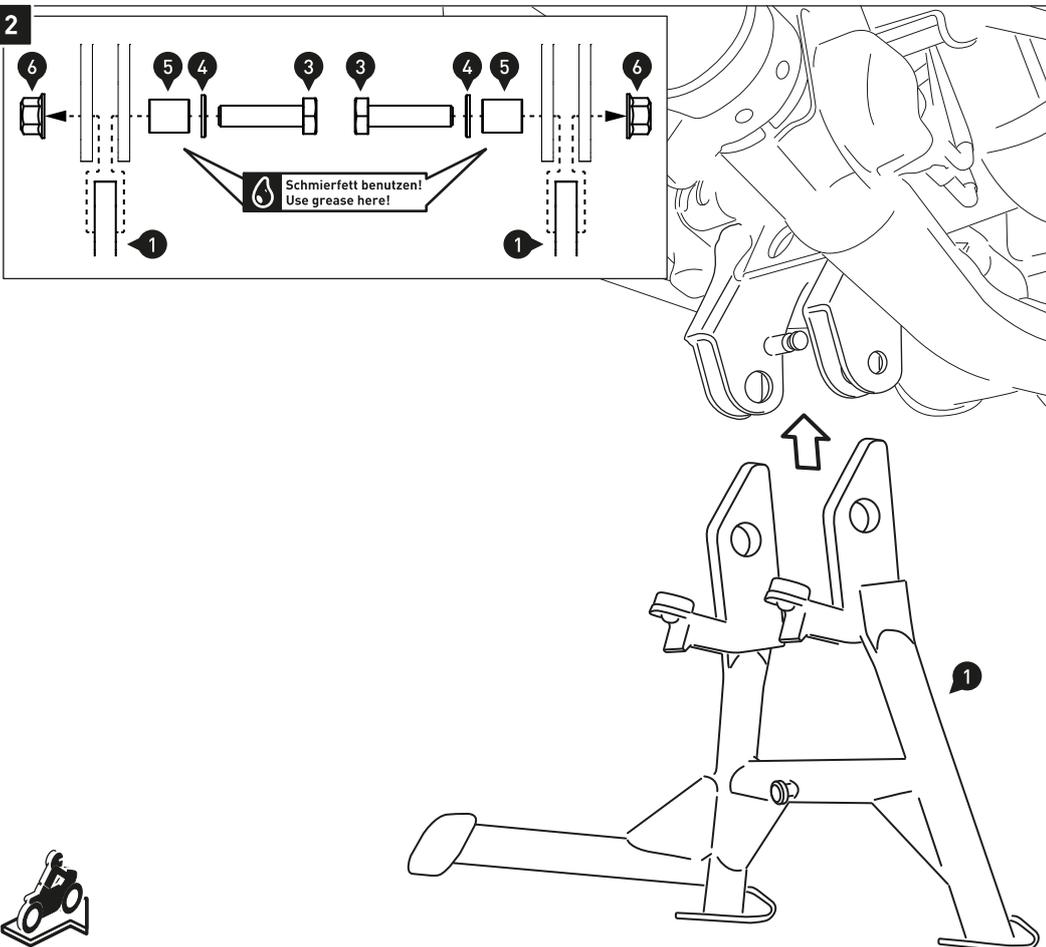
Setzen Sie die Laufbuchsen (5) mit Schmierfett in die Öffnungen des Hauptständers (1) ein, wie in der Detailzeichnung gezeigt.
