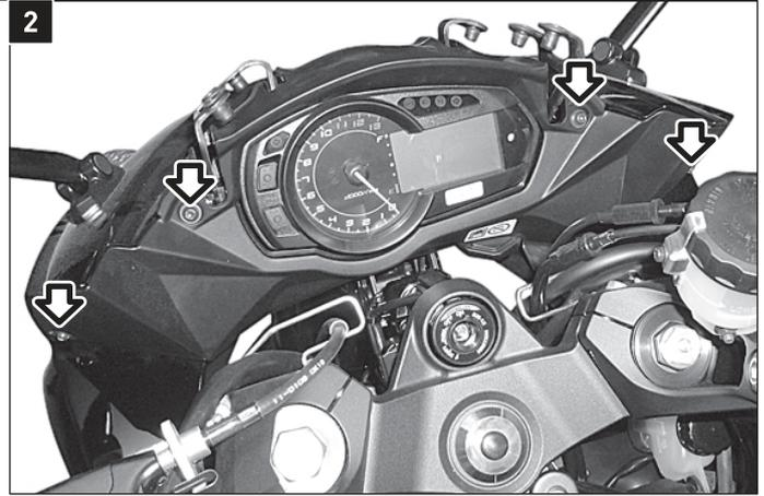
Lösen Sie die markierten Schrauben der Cockpitverkleidung und entfernen Sie diese vorsichtig.
