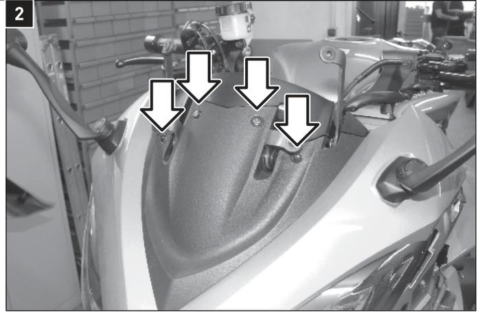
Lösen Sie die markierten Schrauben und Dübel der Frontabdeckung und entfernen Sie diese vorsichtig.
