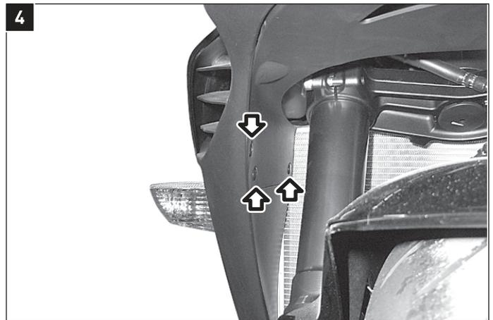
Lösen Sie beidseitig die gezeigten Kunststoffdübel der Seitenverkleidungen.
