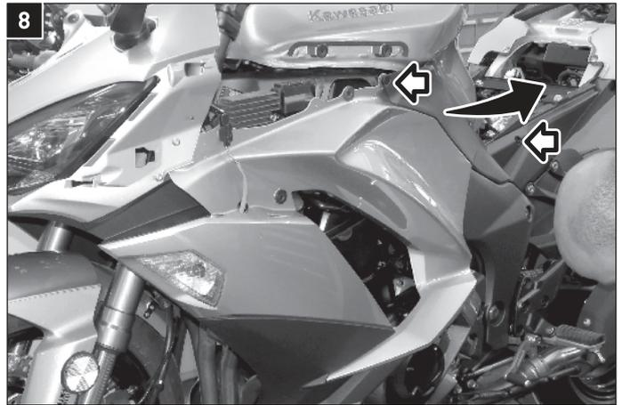
Entfernen Sie die beiden Schrauben und Gummistecker, um beidseitig die Verkleidungsteile abzunehmen.
