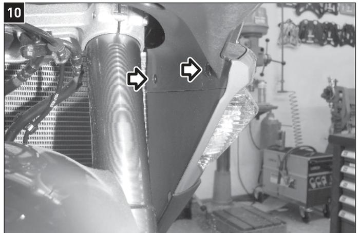
Entfernen Sie beidseitig zwei Dübel auf den Innenseiten der Verkleidung.
