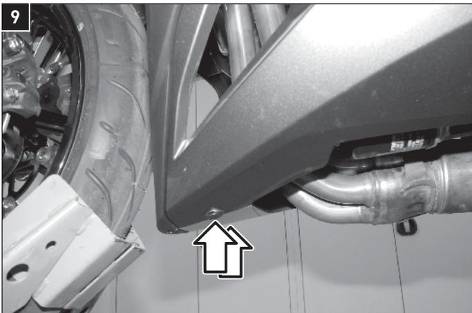
Entfernen Sie die beiden gezeigten Dübel.
