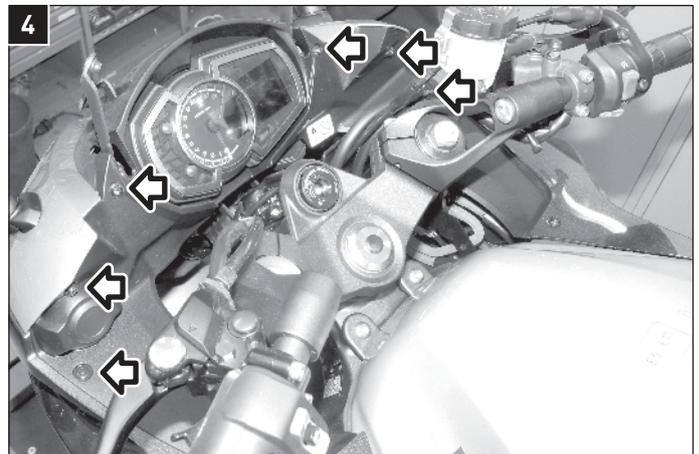
Lösen Sie die markierten Schrauben und Dübel der Cockpitverkleidung und entfernen Sie diese vorsichtig.
