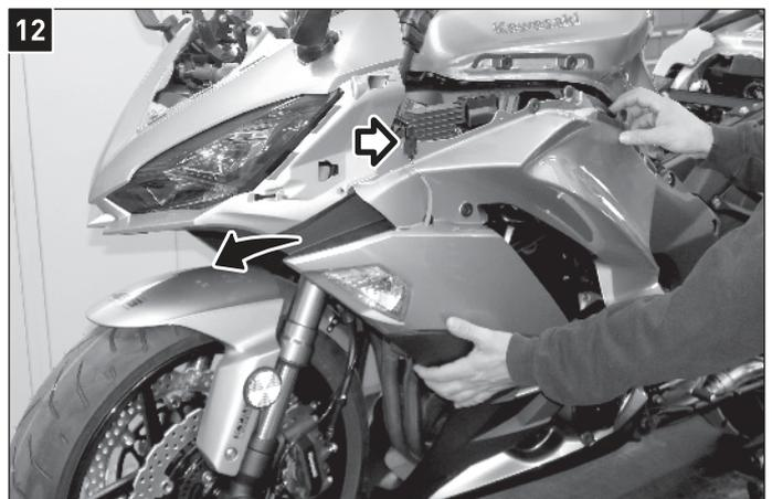
Entfernen Sie beidseitig die Blinkerkabel und nehmen Sie die Seitenverkleidungen ab.
