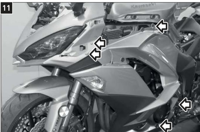
Entfernen Sie beidseitig die fünf Schrauben.
