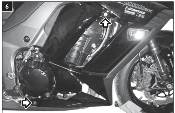
Lösen Sie die markierten Schrauben der rechten Seitenverkleidung und entfernen Sie diese.
