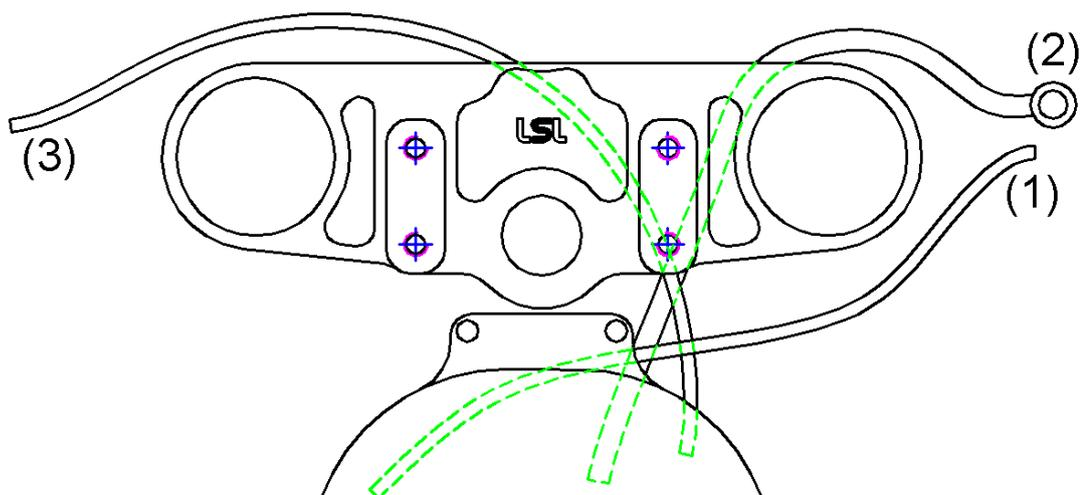
**Câbles des gaz (1):** Démontez l'amortisseur de direction. Desserrer la vis de fixation du radiateur et le débloquer.
