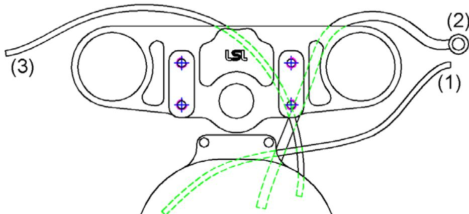
**Gaszüge (1):** Lenkungsdämpfer demontieren. Wasserkühlerverschraubung lösen und den Kühler aus der Arretierung ziehen. Den Gaszug nach rechts verlegen und hinter dem rechten Standrohr zur Griffarmatur führen. Fixieren Sie den Zug mit dem Bremsschlauch an der Halteklemme des Kupplungszugs unter dem Steuerkopf. Gaszug bei voll eingeschlagener Lenkung auf Leichtgängigkeit prüfen.
