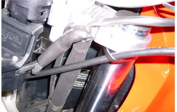
**Armaturenkabel (5&6):** Originalverlegung ohne Fixierung durch Kabelbinder.
