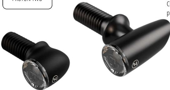
Der PROTON ONE / TWO wird mit einer M8 Mutter verschraubt. Verwenden Sie den mit im Lieferumfang enthaltenen Federscheiben. Wir empfehlen die PROTON ONE / TWO handfest anzuziehen, um Beschädigungen zu vermeiden. / The PROTON ONE / TWO is bolted to an M8 nut. Use the spring washers supplied. We recommend tightening the PROTON ONE / TWO by hand to avoid damage.
