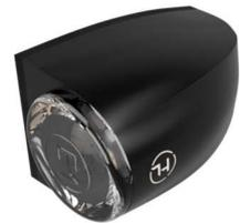
Achten Sie auf die vorgeschriebene Position der ECE/STVZO am Fahrzeug. Vor der Montage reinigen Sie die zu klebende Flächen an einer geeigneten Stelle. Ziehen Sie die Schutzfolie vom Klebepad ab und positionieren Sie den PROTON THREE. Falls Sie ein Loch für die Kabel bohren müssen, achten Sie darauf, dass das Bohrloch nicht zu groß wird, da sonst der PROTON THREE das Loch nicht mehr verdeckt. /
