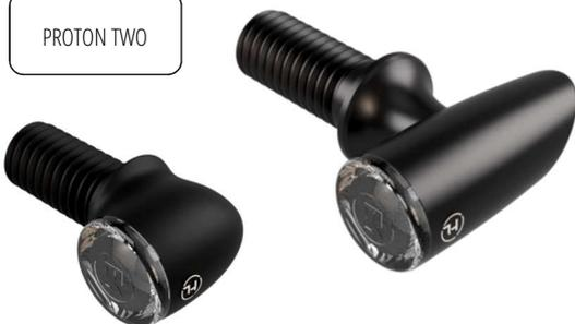
Der PROTON ONE / TWO wird mit einer M8 Mutter verschraubt. Verwenden Sie den mit im Lieferumfang enthaltenen Federscheiben. Wir empfehlen die PROTON ONE / TWO handfest anzuziehen, um Beschädigungen zu vermeiden. / The PROTON ONE / TWO is bolted to an M8 nut. Use the spring washers supplied. We recommend tightening the PROTON ONE / TWO by hand to avoid damage.
