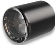
Das PROTON Modul ist zum Verkleben oder Laminieren. Achten Sie auf die vorgeschriebene Position gemäß ECE/STVZO am Fahrzeug. Achten Sie beim Einkleben oder Laminieren auf eine gute Wärmeableitung. Das PROTON Modul nicht an leicht entzündliche Stellen verbauen z. B. Tank, Kraftstoffleitung usw. Vor der Montage reinigen Sie die zu klebende Flächen an einer geeigneten Stelle. /
