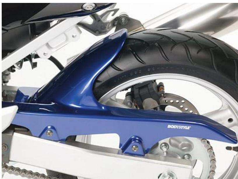
1. Montieren Sie die Hinterradabdeckung mittels der mitgelieferten Schrauben und U-Scheiben.
