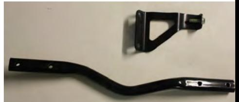
5. Montieren Sie nun zuerst den oberen Krümmer und setzen Sie den Halter von oben auf den Halter am Heck und führen Sie die Befestigungsschraube von oben durch (siehe Bild) ohne diese zu verschrauben.
