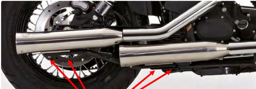
Verschraubungen des Endschalldämpfers am Original-Halter
