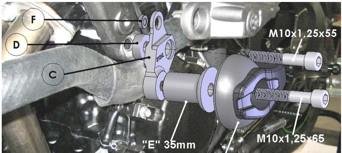
**Hinweis:** Zur spannungsfreien Montage die Verkleidung an den Auflagepunkten auf den Schrauben leicht aussparen.
