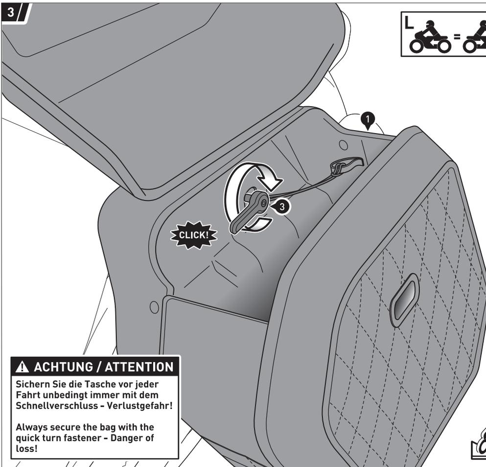
Sichern Sie die Tasche (1) mit dem Schnellverschluss (3), indem Sie den Schnellverschluss-Griff in die Öffnung einsetzen und im Uhrzeigersinn drehen. Achten Sie dabei auf das deutlich hörbare Einrastgeräusch.
