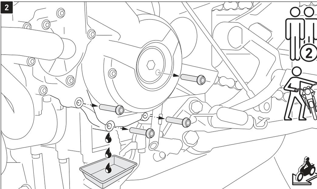
**ACHTUNG: Nach Demontage der markierten Schraube kann es zu einem geringen Flüssigkeitsaustritt kommen! Führen Sie aus diesem Grund die Montage zügig durch! Durch eine Schräglage des Fahrzeugs kann der Austritt verringert werden. Lassen Sie sich dabei von einer zweiten Person helfen.**
