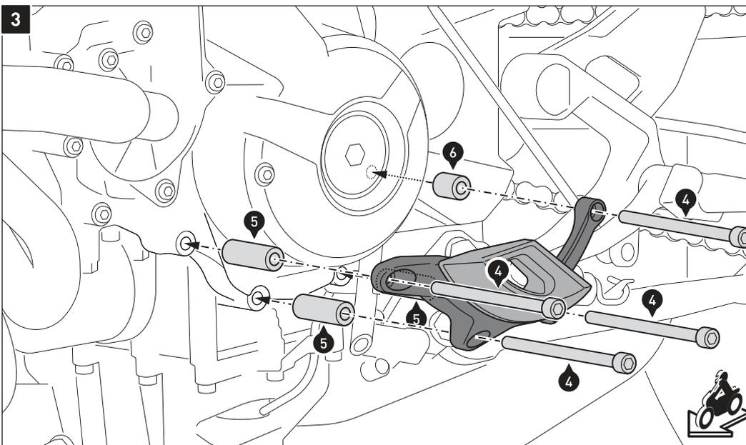
Verschrauben Sie den Motorgehäusesedeckelschutz am Fahrzeug, wie in der Zeichnung gezeigt.
