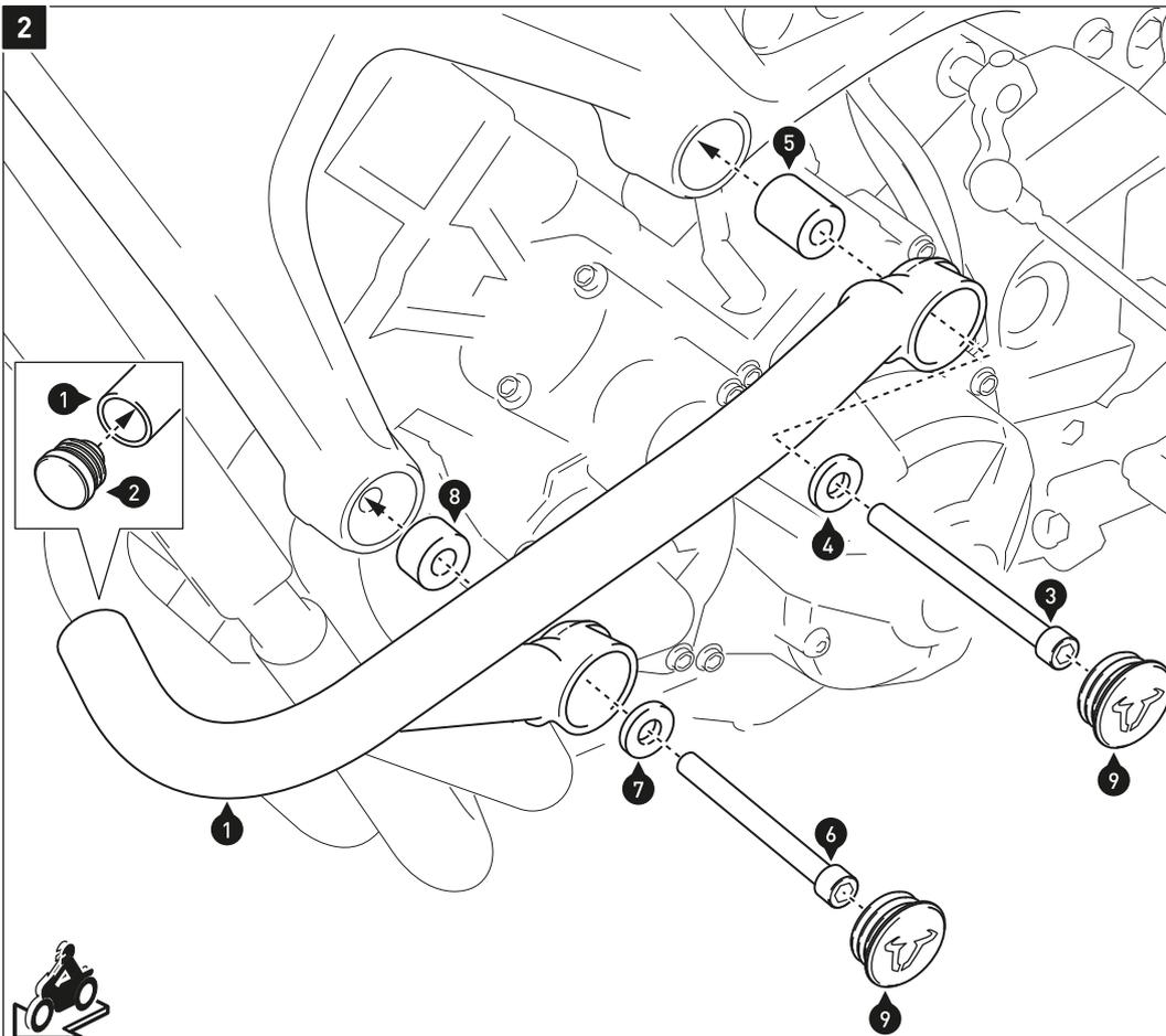
Setzen Sie den Kunststoffendstopfen (2) in den Schutzbügel (1) ein.
