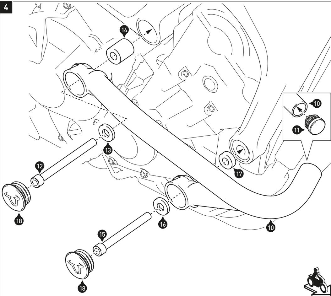
Setzen Sie den Kunststoffendstopfen (11) in den Schutzbügel (10) ein.
