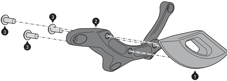
Montieren Sie das Oberteil (1) mit dem Unterteil (2), wie in der Zeichnung gezeigt.
