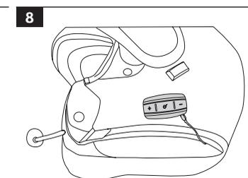
Die Steuerung montieren
